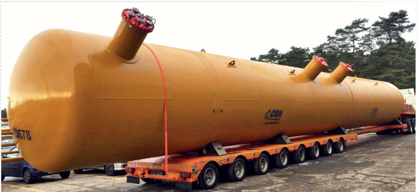
Projekt Baltische Länder, LPG-Terminal: 3 x 200 m 3 , Ø 3200 mm
