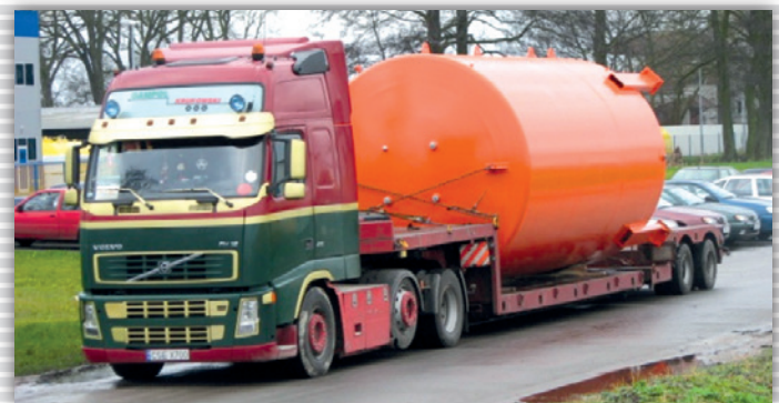
Spezieller 51 m 3 -Tank mit einem Durchmesser von 3200 mm
